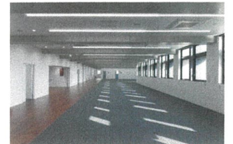
日射量の調整 ライトシェルフと縦ルーバーの組合せにより執務室内の日射量を調整すると共に、昼光センサー付きのLED照明によって適切な照度を確保
