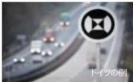
▲位置情報表示施設による自己位置補正の補助
