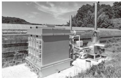
農園に設置された炭化炉：静岡県牧之原市
