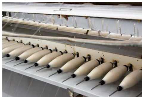
水燃り八丁燃糸。水をそそぎながら、緯糸に1メートルあたり3000～4000回転の強いヨリをかける
