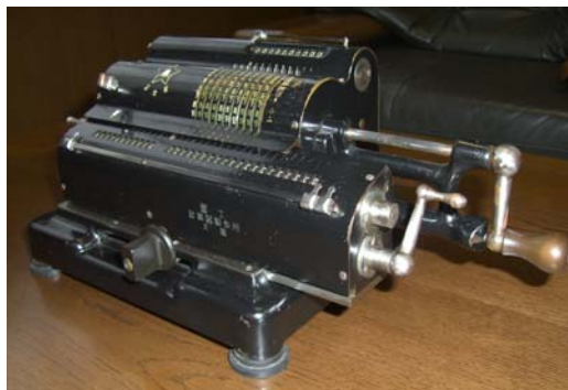
▲現存する日本計算器製の手動計算器 (資料提供：(株)峰山鉄工所)
