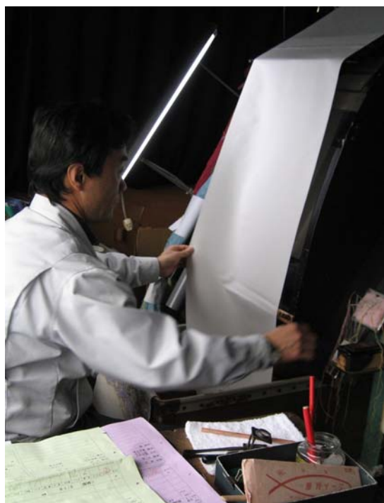
▲検反機による丹後ちりめんの検査風景
