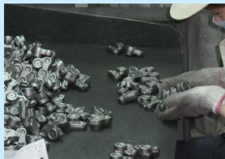
▲(株)峰山鉄工所の全数検査の様子
