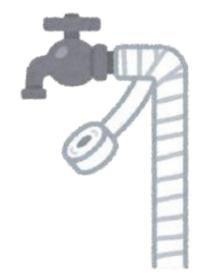
水道管が露出している場合は、保温材で覆うなどの凍結防止対策を行ってください。
