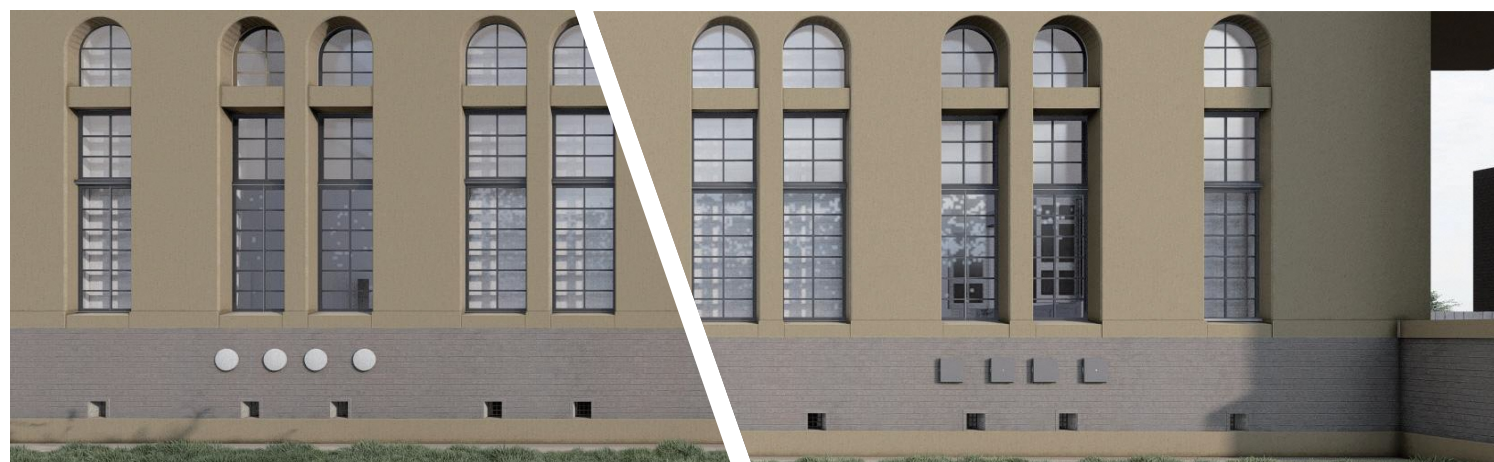
■ 外観パース 外壁に貫通する全熱交換器のキャップは意匠デザインに配慮する
