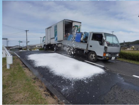
人工降雪機による積雪路の再現
