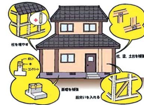
地震に備え耐震補強
